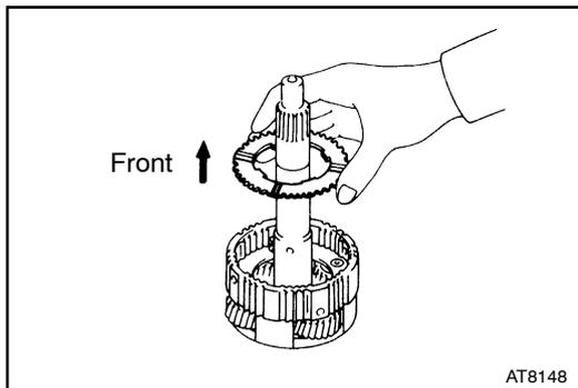
**ASSEMBLY OF OVERDRIVE PLANETARY GEAR, OVERDRIVE DIRECT CLUTCH AND OVERDRIVE ONE-WAY CLUTCH**
