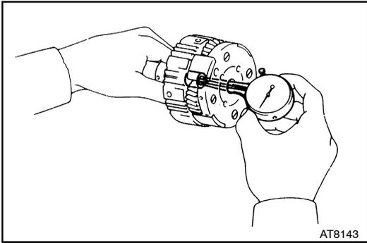
**4. CHECK OVERDRIVE PLANETARY GEAR BUSHING**
