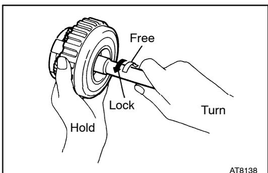
**10. CHECK OPERATION OF ONE-WAY CLUTCH**
