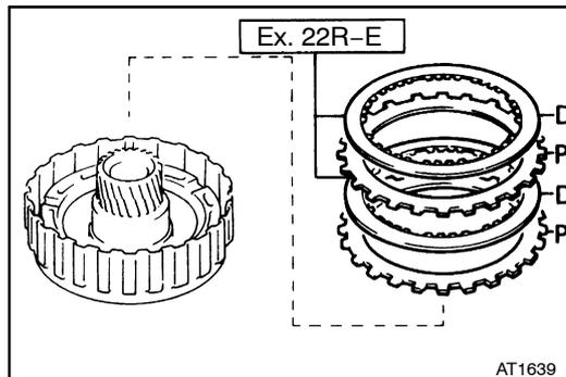
**7. INSTALL PLATE(S), DISC(S) AND FLANGE**
