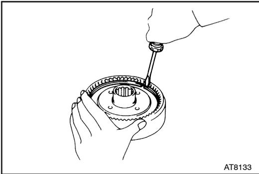
**7. REMOVE RING GEAR FLANGE**
