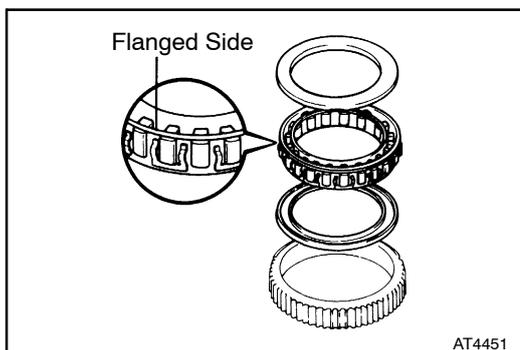
**2. INSTALL OVERDRIVE ONE-WAY CLUTCH**
