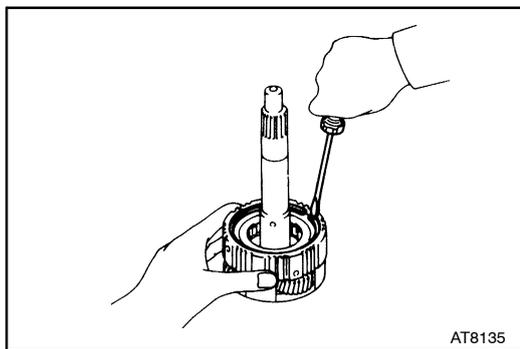
**8. REMOVE RETAINING PLATE**
